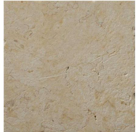
**ج-المعتق مع أو بدون تكسير أطراف ولكن بدون ضرب رمل (ضرب أسيد فقط):** حيث يتم في هذا الفنش غسل وجه الحجر بحمض الهيدروكلوريك فقط. ويصلح هذا فقط لأصناف الحجر الطرية والتي تتفاعل مع الحمض بسهولة ومن أشهر أنواع الحجر التي تصلح لهذا الفنش هو حجر تفوح الطري.
